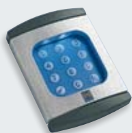
Кодовый радиозамок FCT 10b для 10 функций, с подсветкой клавиш и пленочной клавиатурой, стойкой к атмосферным воздействиям
